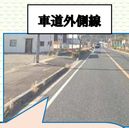
車道外側線 左側に歩道が設置されているので路側帯ではない。車道の一部となる
